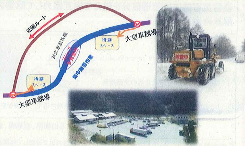
豪雪災害時は、交通規制を行い、除雪優先路線を集中除雪します。そのため、幹線道路ではスリップ多発箇所へ牽引車両の配置を計画するとともに、大型車等を誘導できるよう道の駅等を「待避スペース」として全13建設事務所に275箇所を設定します。また、トラックの雪道装備徹底を積極的に広報します。
