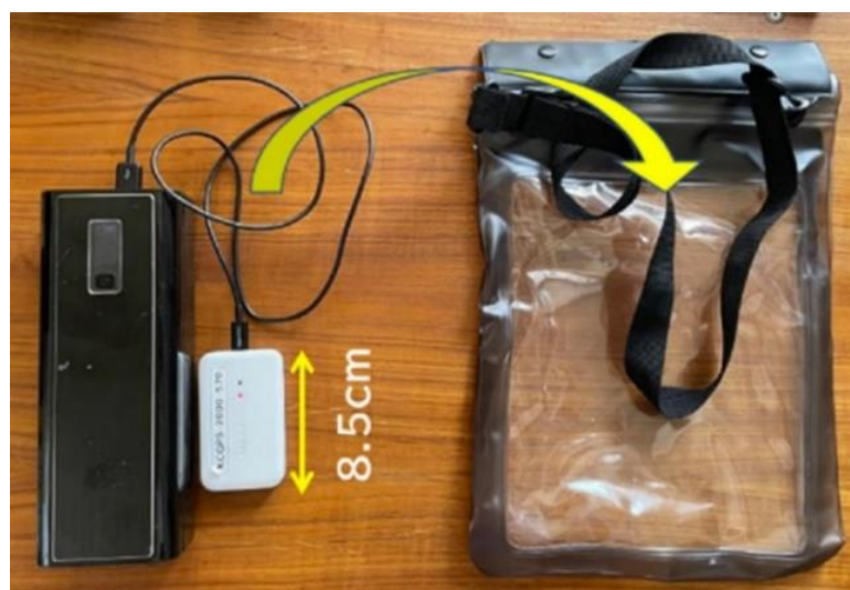
写真2 登山道他に設置するレシーバー 左からバッテリー、GPSトラッカー、収納ケース。
