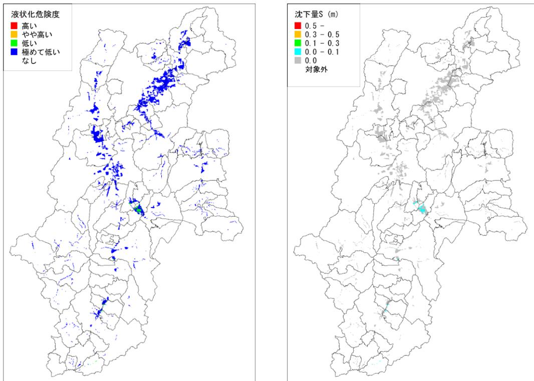
図 4.3-8 想定東海地震の液状化危険度（左）・沈下量（右）
