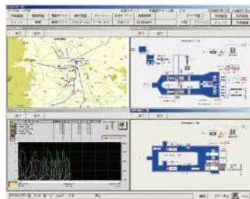
モニター画面に表示された穂高中継ポンプ場、有明中継ポンプ場の運転管理状況
