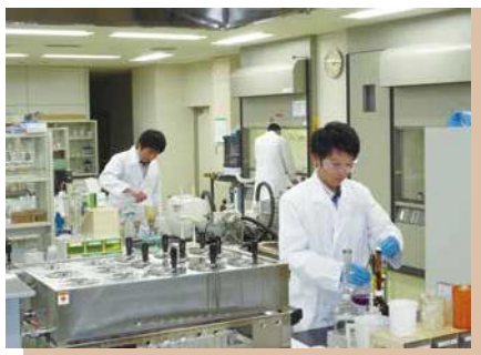
化学的酸素要求量 (COD) 測定 [右手前]、浮遊物質量 (SS) 測定 [左中央]
