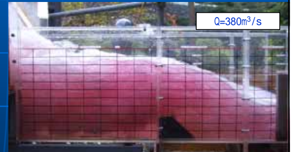
非常用洪水吐き減勢工流況
