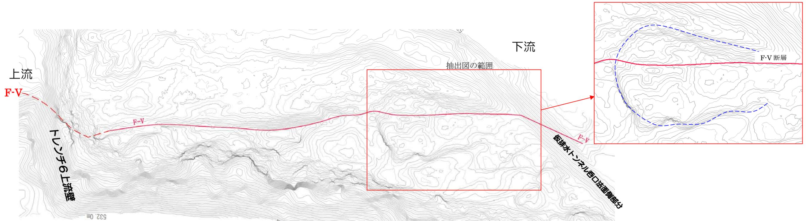
図 5.4.3 仮排水トンネル呑口～トレンチ 6 の岩盤面の 5cm 等高線図
