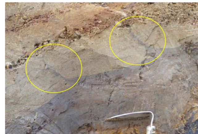
写真 5.2.59 仮排水トンネル呑口～トレンチ 6 の間の山側法面に現れた、ピラー構造\*1とみられる構造。有機質砂層は段差を生じているが、段差は同層の下限には認められない
