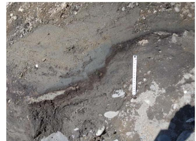
写真 5.2.51 トレンチ 1' のたわみに発達する段差。段差をもつ面の長さは、10~15cm 程度である。
