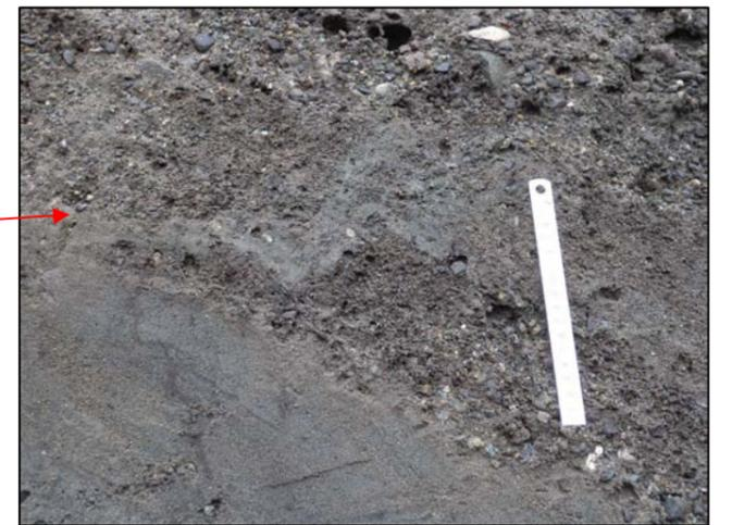
写真 5.2.67 噴砂跡と見られる構造
