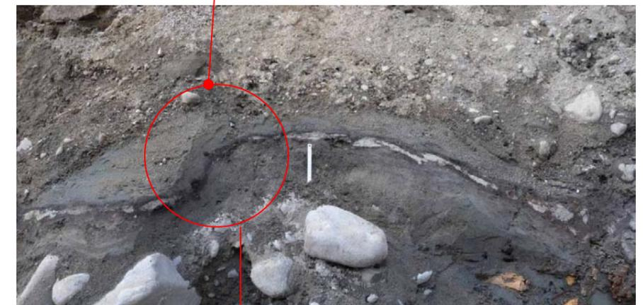
写真 5.2.56 トレンチ1'中央壁面のたわみに見られる逆断層的な段差
