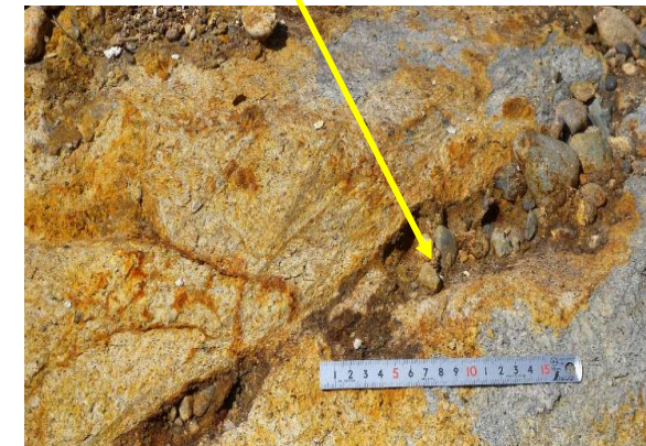
写真 5.1.16 酸化が顕著な割れ目に挟まる砂礫。割れ目の面は浸食を受けて湾曲している。密着部において鏡肌や条線は認められない。
