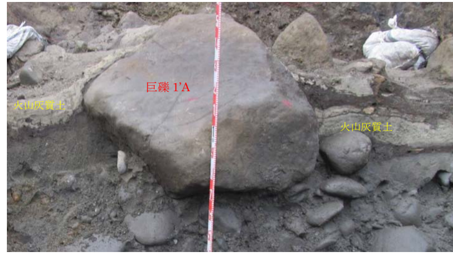
5 回目追い込みの後にさらに追い込み、巨礫上の地層を撤去して巨礫背後よりの状況を確認。巨礫 1'A の左側のたわみは緩やかになり、火山灰質土の層厚変化が顕著。
