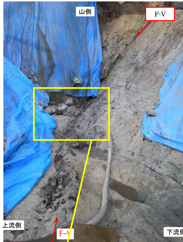
写真 3.11.2 写真 3.11.1のクローズアップ F-V断層に沿って、粘土混じり細片化帯に砂礫(SG-5)が混在した状態が連続するものの、破碎帯の内部や上盤および下盤側境界に鏡肌や条線は確認されない。
