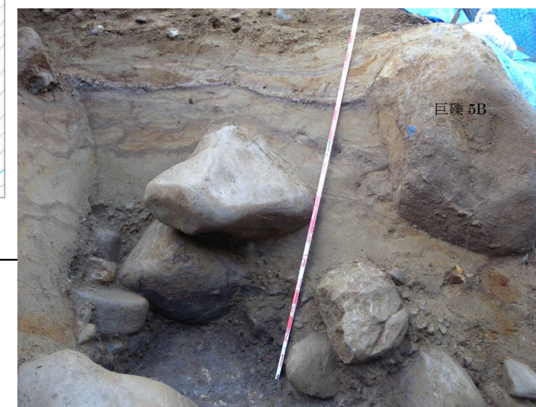
写真 5.2.23 トレンチ5山側壁② 巨礫5Bの上にたわみが認められる。たわみの軸は巨礫5Bの外形に沿っているが、当壁面付近ではほぼF-V断層とは高角度で斜交する方向。
