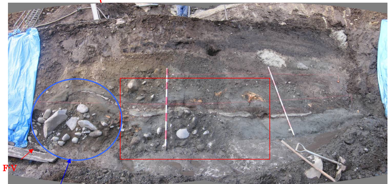
写真 5.2.20 巨礫が密集して砂礫層の上面が高まっており、直上の有機質土と火山灰質シルトがたわんでいる。
