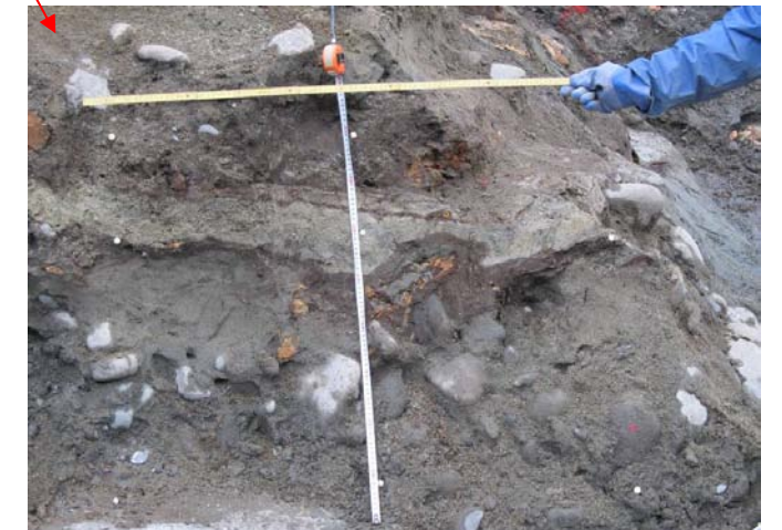
写真 5.2.12 写真 5.2.11 の断面写真。下位に砂礫が密集しその上位の有機質土層にたわみが認められる。
