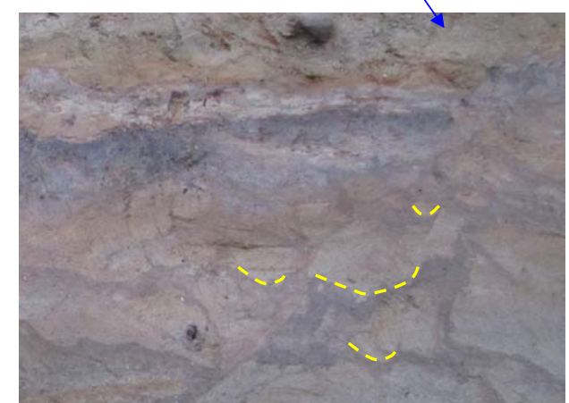
写真 5.2.34 下流壁③の右側に認められる不規則な地層の段差。砂層中に介在する有機質の砂層が乱れており、その中に筋状の段差や皿状構造状の下に凸いたわんだ形状 (図中の黄線) が認められる。
