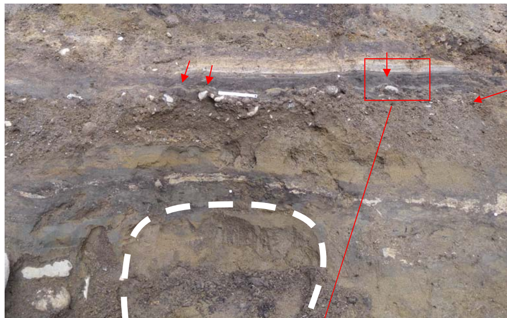
写真 5.2.9 巨礫を除去した痕跡 (白破線で示した範囲) の上を、有機質土層等が緩やかにたわんでいる。赤矢印はさらに小規模なたわみを示す。
