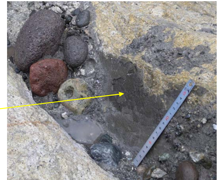
写真 3.11.5 F-V断層(左)とクローズアップ(右) 黄矢印で示す断層面に擦痕は認められない。
