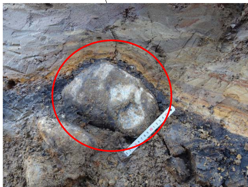
写真 5.2.25 礫に沿って有機質土層がたわんでおり、礫の上部は有機質土層が薄くなっている。(図 5.2.17 の範囲)
