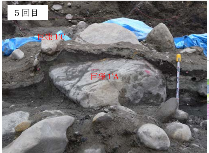
巨礫 1'A により、有機質土や火山灰質土が一部欠層している。巨礫 1'C の下方では、有機質土が M 字型にたわんでいる。
