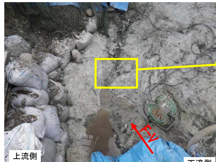
写真 3.11.3 トレンチ1': 砂礫(SG-5)を剥いだ岩盤面におけるF-V断層 トレンチ1'~3へ連続するF-V断層の遠景。延長方向には、破碎帯が確認される。
