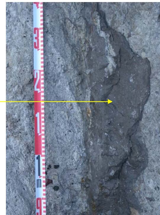
写真 5.1.35 F-V 断層 (左) とクローズアップ (右) 黄矢印で示す断層面に擦痕は認められない。
