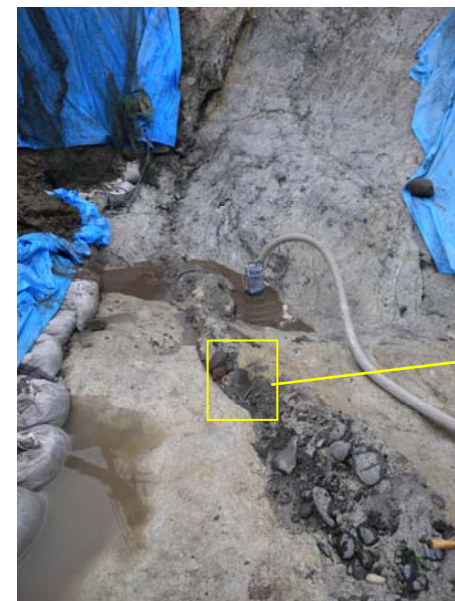
写真 3.11.5 F-V断層(左)とクローズアップ(右) 黄矢印で示す断層面に擦痕は認められない。
