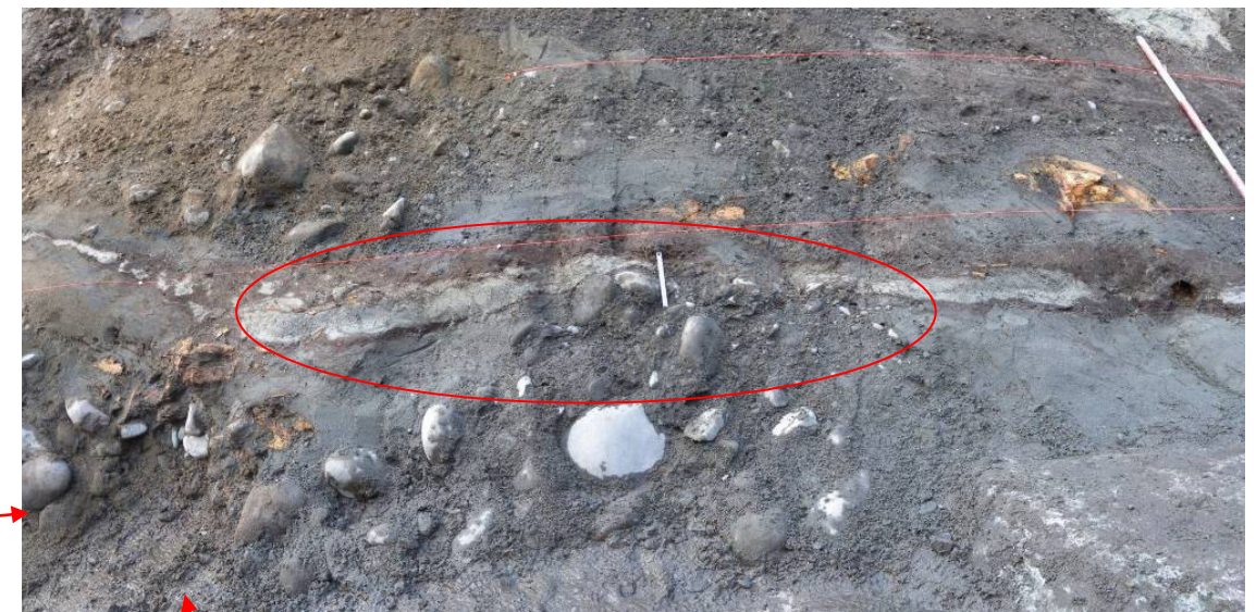
写真 5.2.19 巨礫が密集しており、直上の有機質土と火山灰質シルトが緩やかにたわんでいる。
