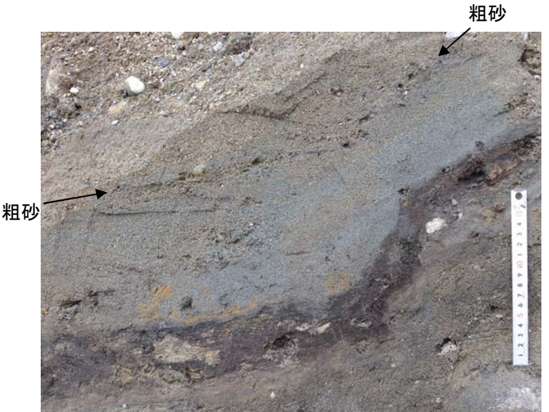
写真 5.2.28 たわみ左側翼部 有機質土層の10cm程度上位に重なる粗砂の薄層たわみの程度は緩やかで、有機質土層と粗砂の間の細砂層の厚さが軸部に向けて薄くなる。
