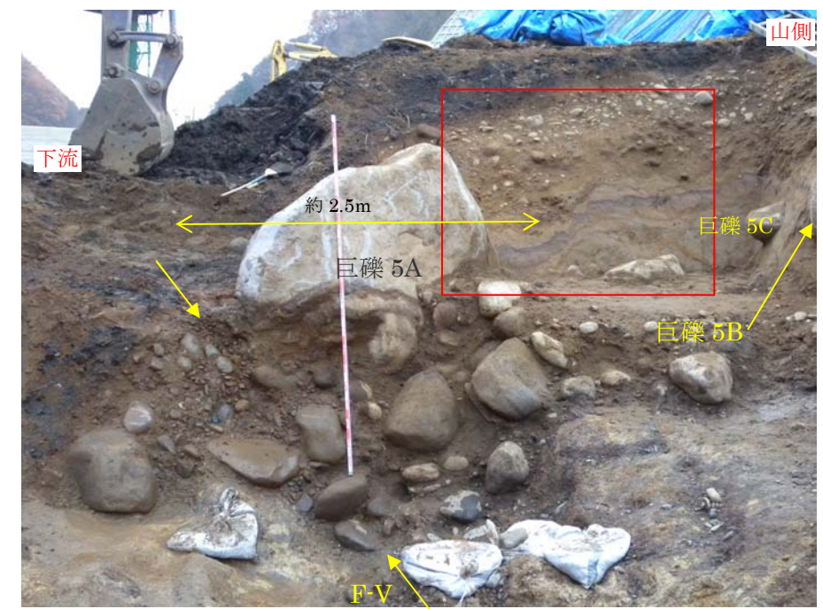
写真 5.2.14 トレンチ 5 下流壁③ 巨礫 5A は F-V 断層の直上付近に位置している。
