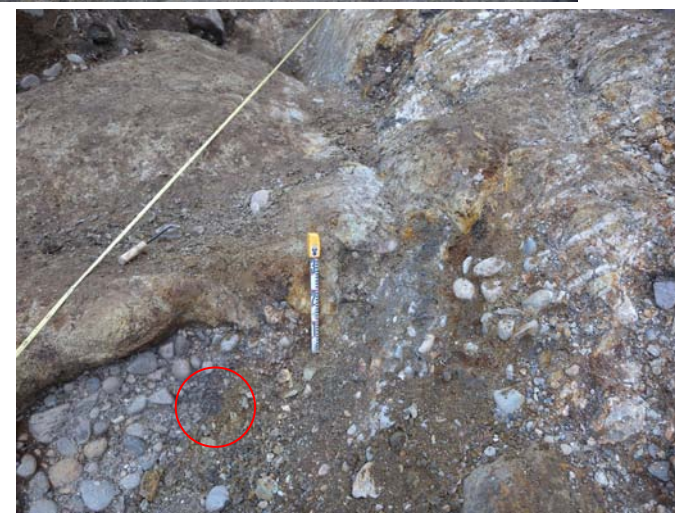
写真 3.4.5.4 調査範囲の下流部の凹みに付着する締まりの良い砂礫。年代測定の結果、BP.6680±40y の結果となった(赤丸が試料採取位置)。図 3.4.5.1 参照
