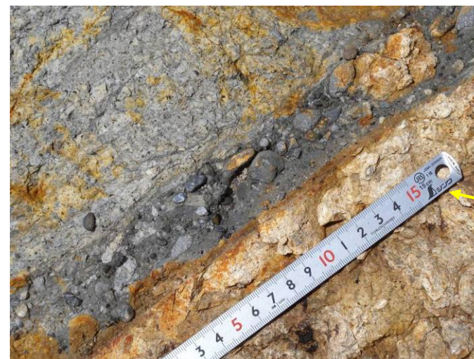
写真 3.4.3.7 F-V 断層に落ち込んでいる粘土と円礫
