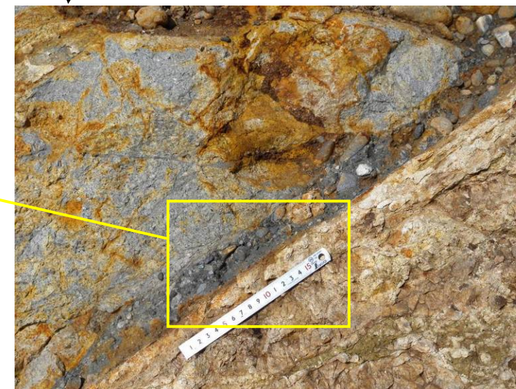
写真 3.4.3.7 F-V 断層に落ち込んでいる粘土と円礫
