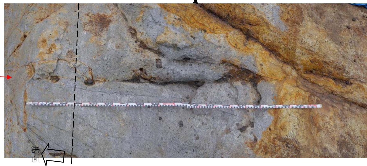
写真 3.4.5.14 写真 3.4.5.8 の割れ目と交差する方向の割れ目（面が粗く、鏡肌も条線も認められない）に落ち込んだ砂礫（左写真は川側から斜めに、右写真は上から撮影）
