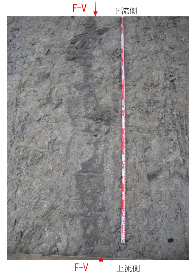
写真 3.1.2.8 調査を実施した堤敷下流端付近の F-V 断層 (粘土化帯～粘土混じり細片化帯)
