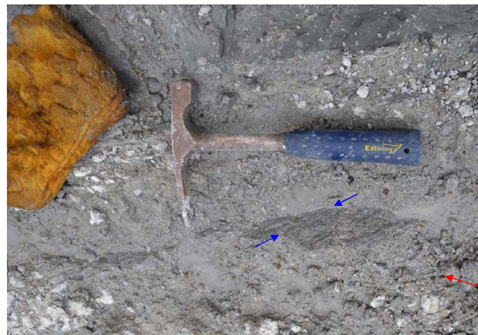
写真 1.1.4 F-V 断層の近傍に発達する F-V 断層と平行な破砕面に見られる条線。 矢印の位置では、上流側に 12° 落とし
