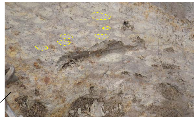
写真 3.4.2.7 有機質土とテフラの細互層中に皿状構造（注）と見られる構造が認められる。
