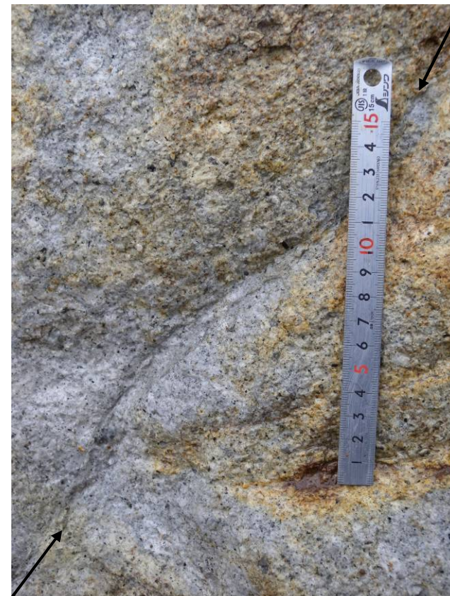
写真 3.4.2.4 写真 3.4.2.3 から 20cm 深い箇所。面は完全に密着し、不連続面としては不明瞭。
