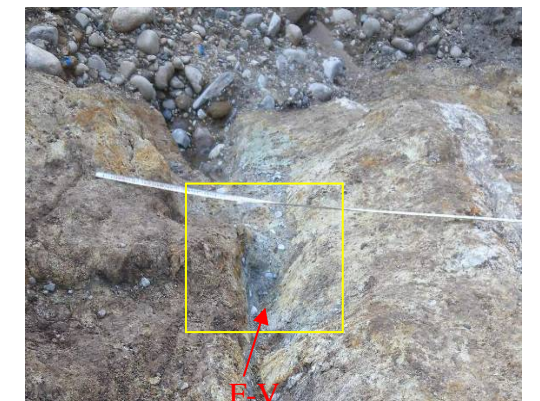
写真 3.4.5.5 F-V 断層部の拡大砂礫層を挟む
