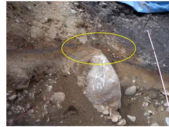
写真 3.4.1.4 有機質土層：礫の周囲をとりまくようにたわんでいる箇所。
