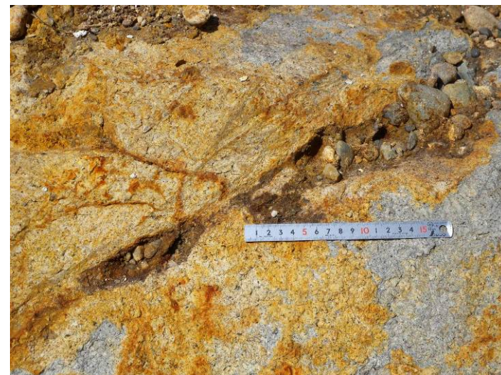
写真 3.4.3.9 酸化が顕著な割れ目に挟まる砂礫。割れ目の面は浸食を受けて湾曲している。密着部において鏡肌や条線は認められない。
