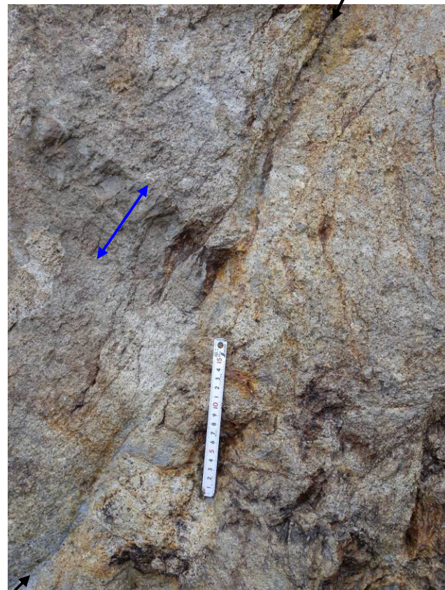
写真 3.4.2.3 断層近景。上盤側のやや暗色味を帯びた層(青矢印)が途切れており、断層とわかる。岩盤面から0.5m程度の深さでは密着している。
