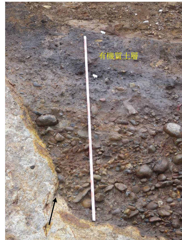
写真 3.4.2.5 断層直上の砂礫層、有機質土層とも乱れはなく、層状構造が連続する。
