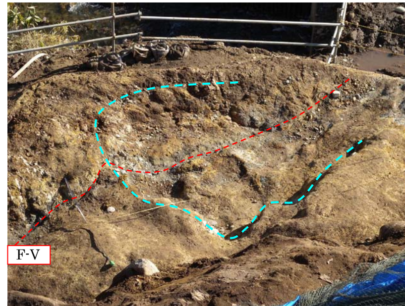
写真 3.4.5.16 岩盤面の調査範囲下流部の馬蹄形凹み（上流側から見る）
