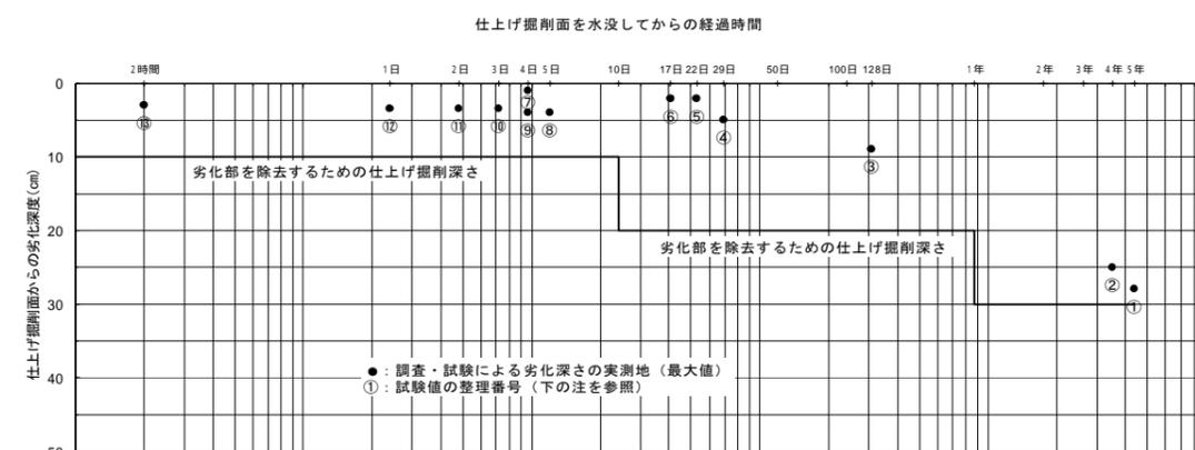
注 ①：掘削後5年を経た調査機坑の踏前を掘削した結果より。踏前は機坑掘削時に清掃してはいるので、劣化深さはかなり深めになっていると考えられる。
