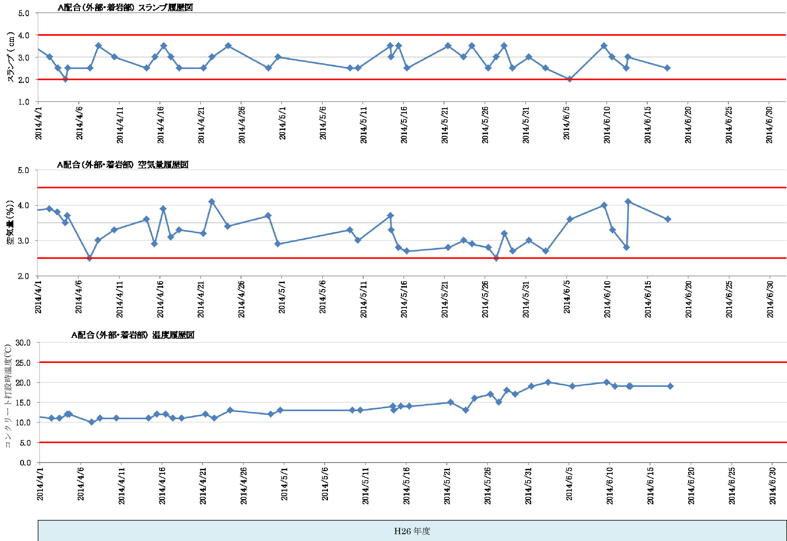
図 3.4.16 コンクリート(A 配合)の品質管理結果
