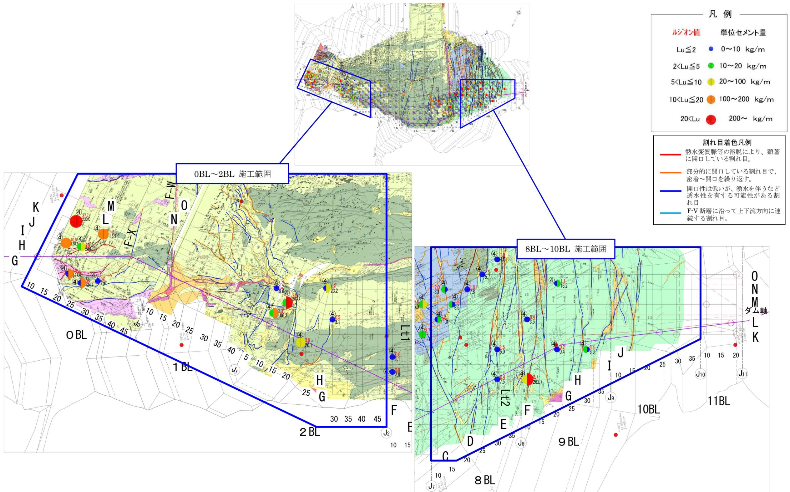
図 3.5.9 遮水性改良目的のコンソリデーショングラウチング実績図 (追加孔4次孔)
