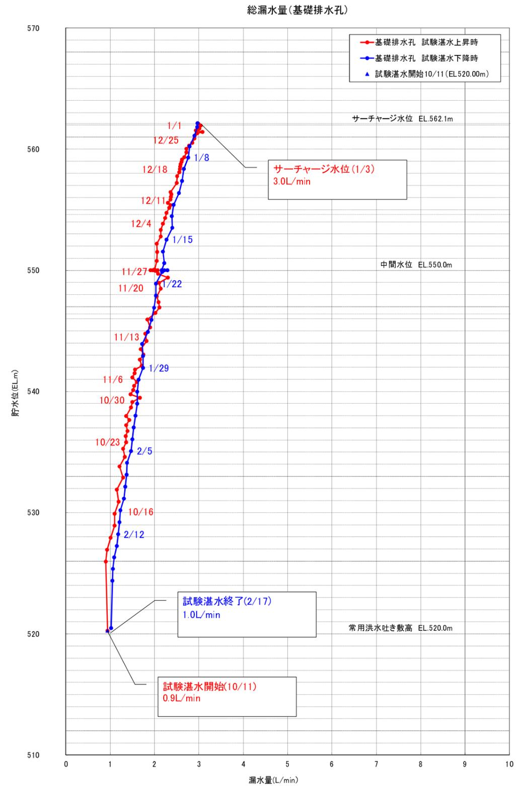
図 3.3.2 総漏水量 (基礎排水孔)
