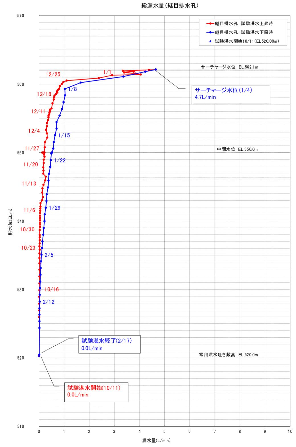
図 3.3.3 総漏水量 (継目排水孔)
