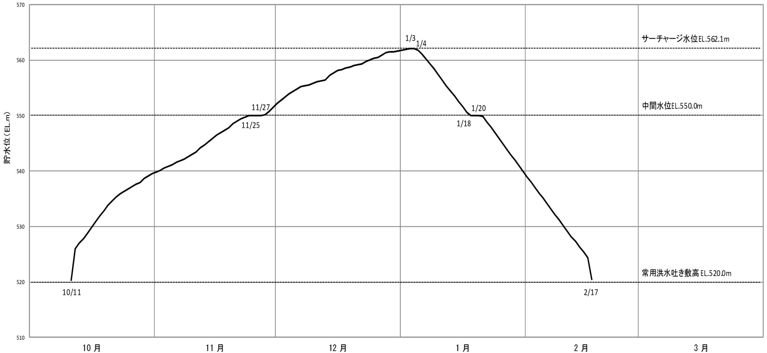
図 3.2.1 浅川ダム試験湛水実績図
