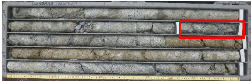
R3-GR3 孔 4st (Lu=0.48, Pc=0.39) 赤囲みが F-V 本体。CL3 級岩盤はない (岩盤変位計孔のため、注入はなし)。
