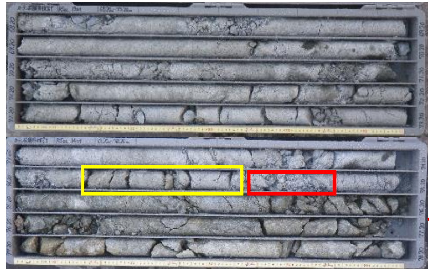
R5-GR5 孔 13st (Lu=0.66 Pc=0.39, 14st (Lu=1.64, Pc=0.19) 赤囲みが F-V 本体。黄囲みは CL-3 級だが狭小 (岩盤変位計孔のため、注入はなし)。
