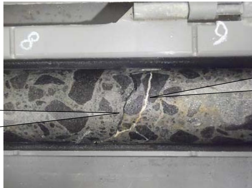
写真 3.4.37 注入材の確認されたクラック例 (No.2 C-02B01)
