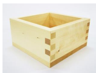
上端留め形五枚組み接ぎ
